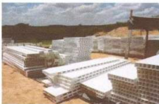
Figura 13 – Painéis de PVC pré-moldados na fábrica
